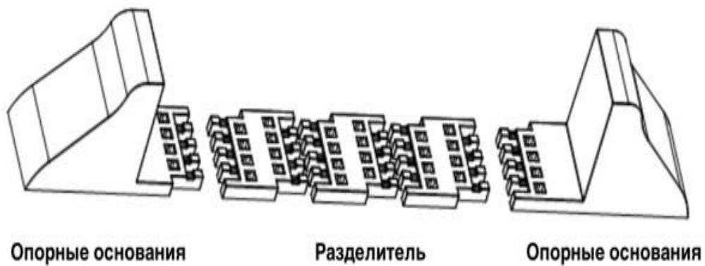
*Рис.4-2 Установка опорных оснований с распорками*
