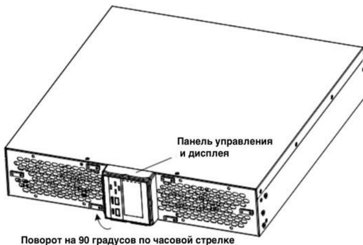
Рис.4-4 Поворот панели управления и дисплея
